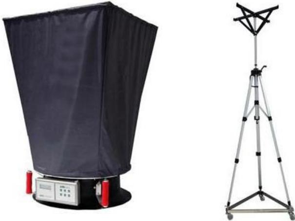
FLY-1 型风量仪可以进行进风口和回风口的测量,为客户带来便利。本厂根据国外同类产品的先进技术,每一台 FLY-1 型风量仪的出厂都通过严格的孔板式标准风洞装置进行多点风量校正,为用户直接测定风量提供可靠的保证。
